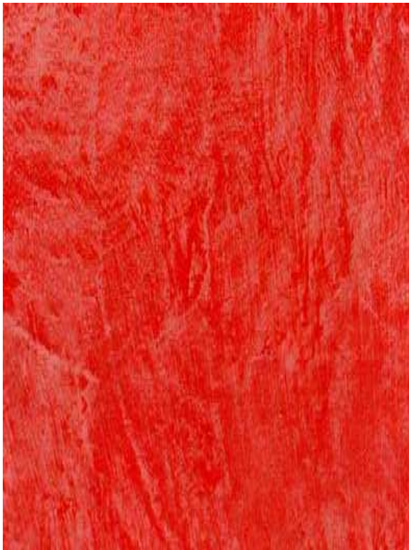
Marmorino fine gemengd met frans .oker Havana oranje gewassen, aarde pigment van Roussillon 5%, met Cera Punica [rubin] behandeld.
